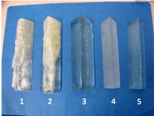
Abb. 7: 1 + 2: erste Schmelzversuche mit Standardglas um 1800; 3: gelungenes Rohprisma; 4: Rohprisma geschliffen; 5: fertig auspoliertes Prisma
